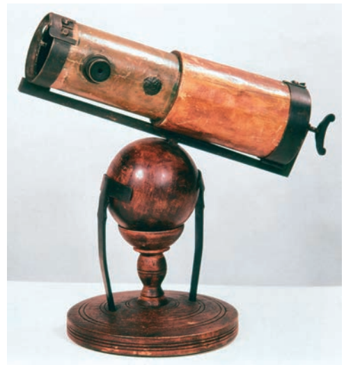
En 1668, Isaac Newton construyó el primer telescopio reflector, el cual producía un aumento de 38 veces.
