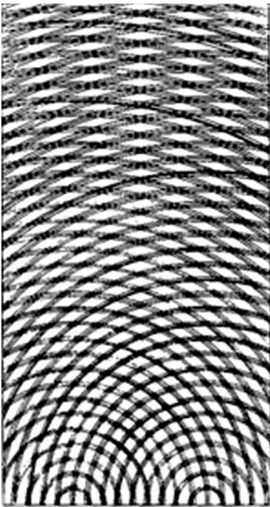
Fig. 1.9. Difracción de ondas de frente recto al incidir sobre una abertura.
