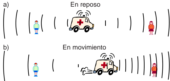
a) Ambos observadores en la banqueta perciben el sonido de la ambulancia que está parada con igual frecuencia. b) Efecto Doppler: el observador hacia el que se dirige la ambulancia oye un sonido de mayor frecuencia, mientras el que está detrás, uno de menor frecuencia.
