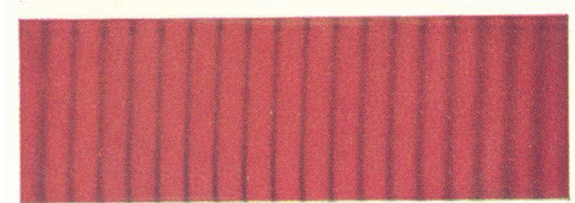
Fig. 4.13. Fotografía de un diagrama de interferencia de luz roja, obtenido con dos rendijas.
