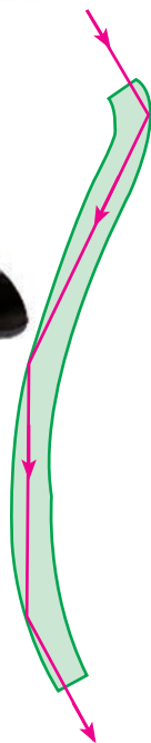
Fig. 3.13. Esquema de la reflexión total interna en una fibra óptica.
