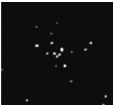
Fig. 4.32. Luz muy débil que incide en el chip de una cámara fotográfica digital. La iluminación no es uniforme, como predice el modelo ondulatorio. A unos pixeles llega luz y a otros no, como se concluye del comportamiento corpuscular.
