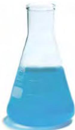
**Fig. 1.15** *Disolución no saturada de sulfato de cobre (II)*. Tomada de: <http://megacientifica.com.br>
