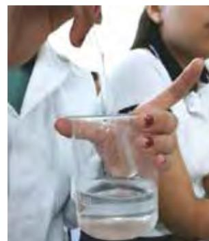
3. Disolución de la sal. A la temperatura ambiente, se añade poco a poco la sal al agua y simultáneamente se agita hasta su disolución. Si la cantidad de sal medida se disuelve por completo, se seguirá adicionando sal hasta la saturación, llevando a cabo un registro de la cantidad de sal agregada.
