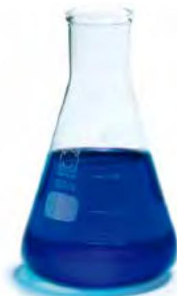
**Fig. 1.16** *Disolución sobresaturada de sulfato de cobre (II)*. Tomada de: <http://watchinf.com>
