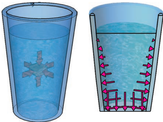
Fig.2.5. La fuerza ejercida por un fluido sobre la superficie de un cuerpo sumergido en él, y también sobre las paredes del recipiente que lo contiene, es perpendicular a la superficie de éstos en todos los puntos.
