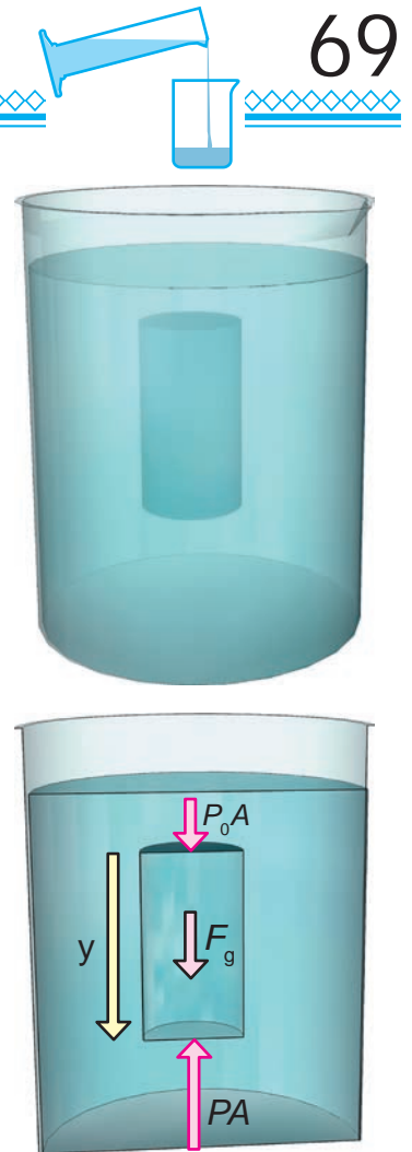
Fig. 2.13. Puesto que la porción de líquido delimitada está en reposo, la suma de las fuerzas ejercidas sobre ella es cero.
