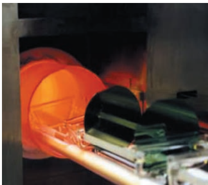
Fig. 1.9. Difusión para obtener la unión PN, elemento fundamental de la mayoría de los componentes electrónicos modernos.
