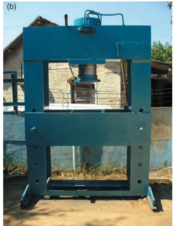
Fig. 2.12. Dos importantes aplicaciones de la ley de Pascal: (a) el elevador hidráulico y (b) la prensa hidráulica, inventada en 1796.
