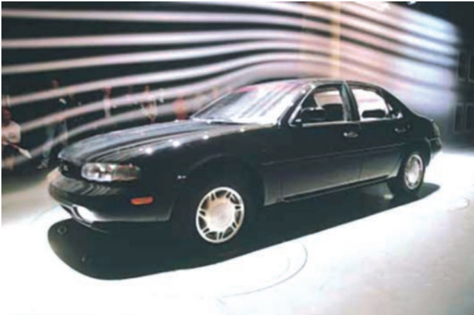
Fig. 2.26. Flujo laminar de aire durante una prueba de las características aerodinámicas de un automóvil.
