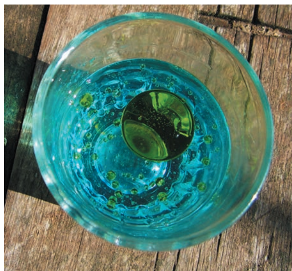
Fig. 1.4. Al dejar caer una gotita de aceite sobre la superficie de agua, se extiende en forma de una delgada película circular.
