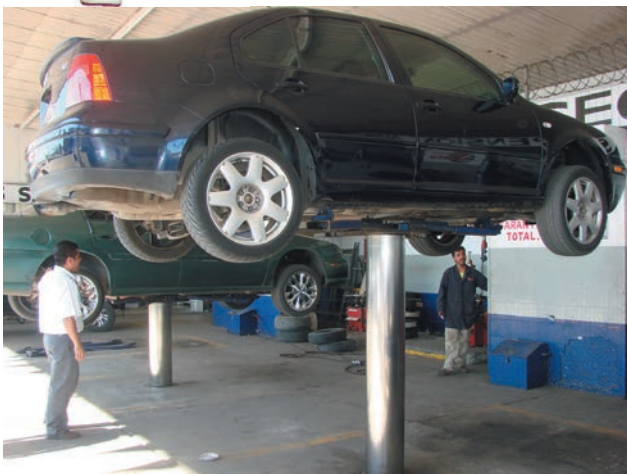
Fig. 2.12. Dos importantes aplicaciones de la ley de Pascal: (a) el elevador hidráulico y (b) la prensa hidráulica, inventada en 1796.
