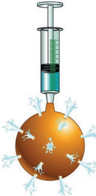
Fig. 2.9. La experiencia con la “esfera de Pascal” ilustra que la presión ejercida sobre líquidos y gases se transmite en todas direcciones.
