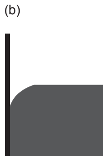
Fig. 3.13. (a) Cuando un líquido moja la pared del recipiente (como el agua), su superficie libre se curva hacia dentro junto a la pared, (b) cuando no la moja (como el mercurio) se curva hacia fuera.
