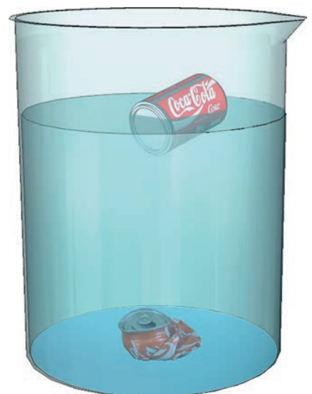
Fig. 2.23. (a) Un pequeño clavo se hunde en agua, mientras que un gran barco flota en ella. (b) Una lata de refresco vacía flota en agua pero aplastada se hunde.
