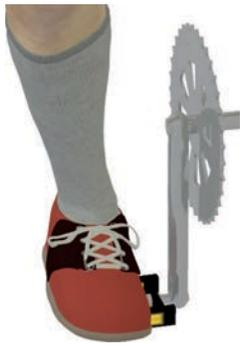
12. Un ciclista de 75 kg apoya todo su peso sobre un pedal, cuyo eje tiene un diámetro de 1.5 cm. Halle el esfuerzo cortante sobre el eje del pedal.
