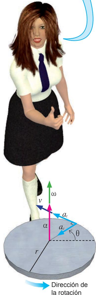
**Fig. 3.15.** Las aceleraciones centrípeta y tangencial se localizan en el plano de corte perpendiculares entre sí, mientras que la velocidad y la aceleración angular se localiza sobre el eje de rotación  $z$ .
