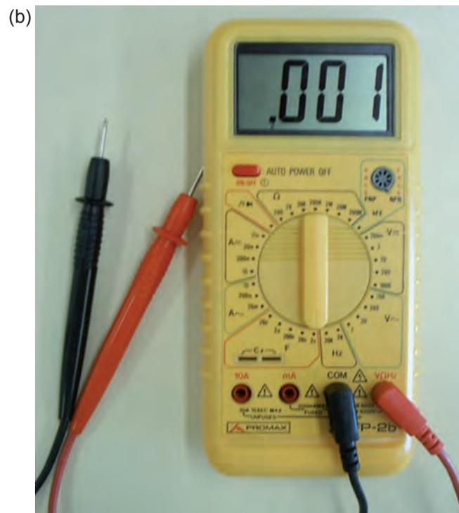
**Fig. 2.10.** (a) Microamperímetro analógico (de aguja). (b) Multímetro digital, utilizado para medir, entre otras magnitudes eléctricas, intensidad de corriente.
