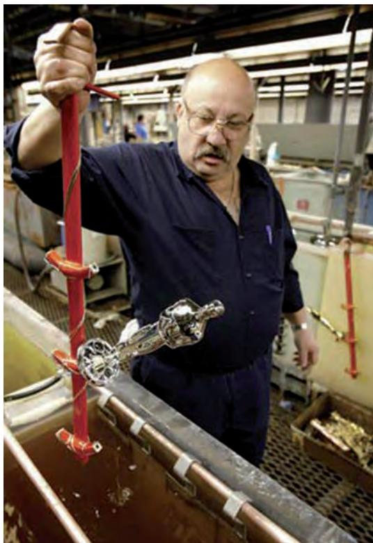
**Fig. 2.21.** Recubrimiento de cuerpos con una capa de metal mediante electrólisis.
