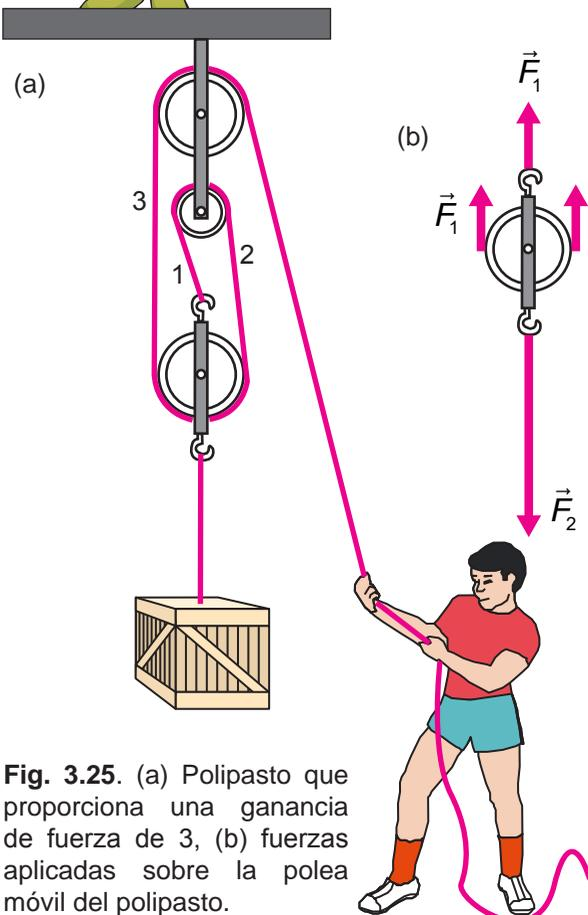
Fig. 3.25. (a) Polipasto que proporciona una ganancia de fuerza de 3, (b) fuerzas aplicadas sobre la polea móvil del polipasto.
