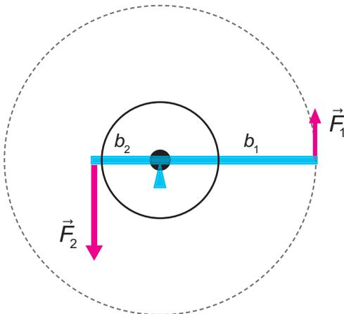
**Fig. 3.27.** El torno representa una palanca con el punto de apoyo en su eje.
