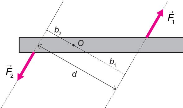
**Fig. 3.11.** Las fuerzas  $\vec{F}_1$  y  $\vec{F}_2$  aplicadas sobre la regla forman un par de fuerzas. La magnitud del momento del par es  $dF$ , donde  $F$  es la magnitud de las fuerzas y  $d$  la distancia entre sus líneas de acción. Por consiguiente, no depende del lugar del cuerpo donde actúan las fuerzas, ni de la dirección de éstas.
