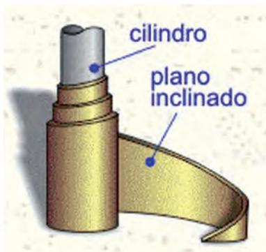
**Fig. 3.30.** Modelo de plano inclinado helicoidal.
