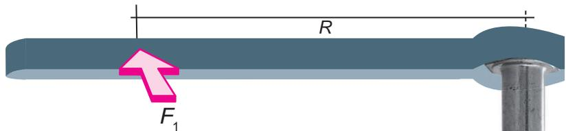
**Fig. 3.33.** Las fuerzas se aplican sobre los tornillos por medio de barras, atornilladores y otros instrumentos.
