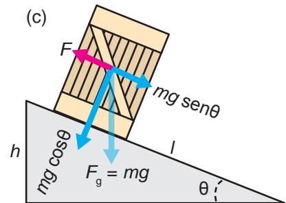
**Fig. 3.28.** (a) Resulta imposible aplicar una fuerza igual al peso  $F_g$  de la carga y elevarla hasta el camión, (b) el plano inclinado permite hacerlo aplicando la fuerza  $F$ , (c) si se desprecia la fricción,  $F = mg \text{sen} \theta$ .
