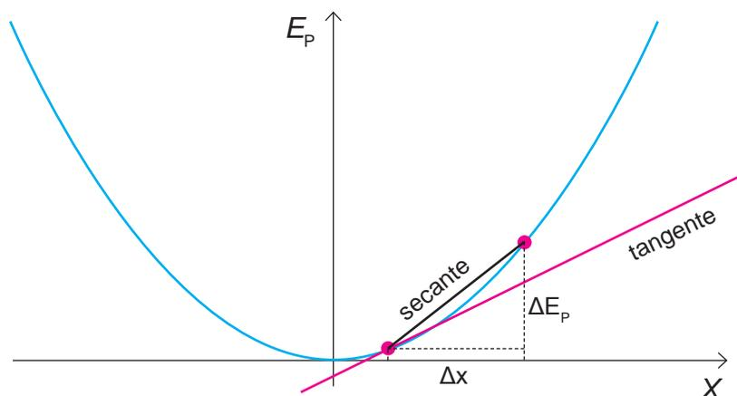
**Fig. 1.26.** La pendiente de la tangente a la curva de  $E_p(x)$ , con signo opuesto, da la fuerza en dicha posición.
