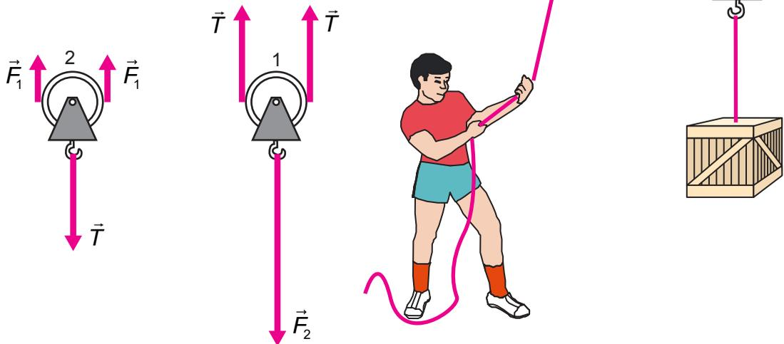
Fig. 3.24. (a) Aparejo formado por una polea fija y dos móviles, (b) Fuerzas aplicadas sobre cada una de las poleas móviles.
