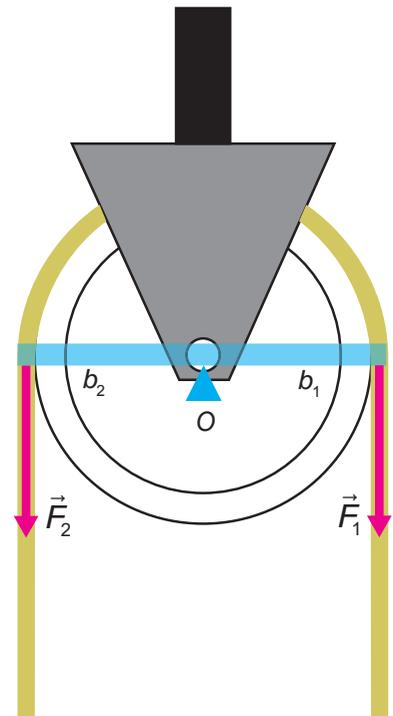
**Fig. 3.20.** Una polea fija puede ser considerada una palanca de primera clase en que los brazos de la fuerza ejercida y la fuerza obtenida son iguales a su radio.
