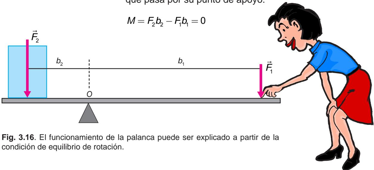
**Fig. 3.16.** El funcionamiento de la palanca puede ser explicado a partir de la condición de equilibrio de rotación.
