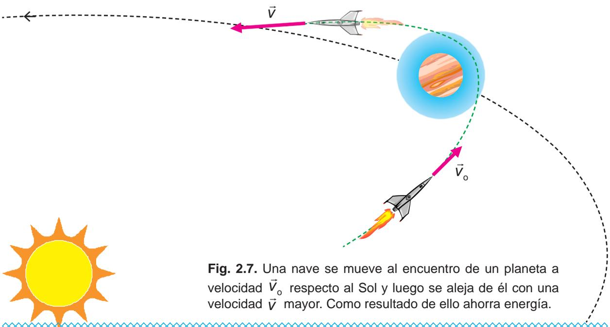
**Fig. 2.7.** Una nave se mueve al encuentro de un planeta a velocidad  $\vec{v}_0$  respecto al Sol y luego se aleja de él con una velocidad  $\vec{v}$  mayor. Como resultado de ello ahorra energía.
