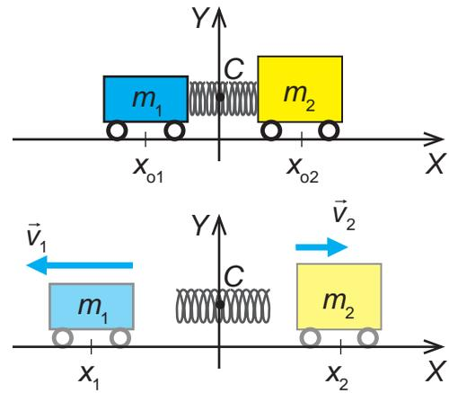
Fig. 2.10. Los carritos se alejan del punto C de tal modo que las distancias a dicho punto son inversamente proporcionales a sus masas.
