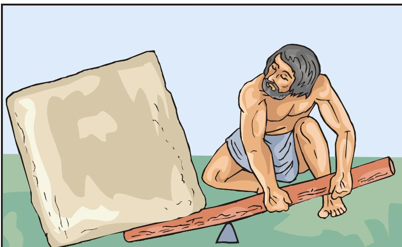
**Fig. 3.15.** La palanca consiste en un cuerpo rígido que se apoya en un punto alrededor del cual puede girar. Mediante ella es posible aplicar fuerzas mucho mayores que las ejercidas directamente.
