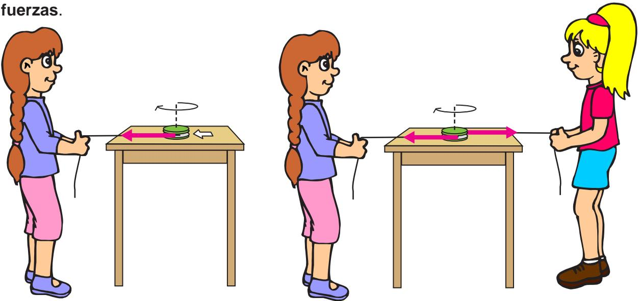
**Fig. 3.10.** (a) Una sola fuerza provoca no solo la rotación del cuerpo sino también su traslación, (b) Un par de fuerza produce la rotación del cuerpo, pero mantiene su equilibrio de traslación.
