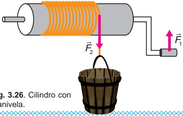
Fig. 3.26. Cilindro con manivela.
