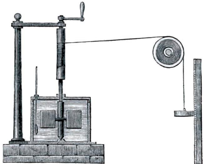
Fig.1.33. Aparato empleado por Joule en la medición del equivalente mecánico del calor.
