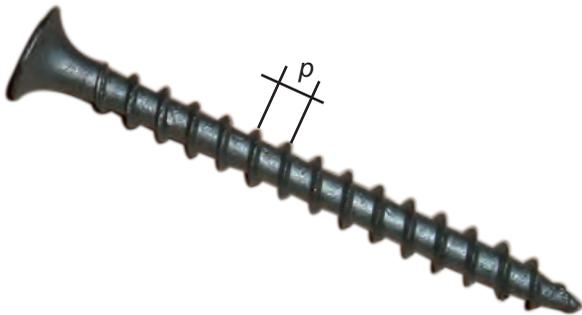
**Fig. 3.32.** La rosca de un tornillo es una especie de plano inclinado helicoidal. La distancia  $p$  entre dos filetes de la rosca es el paso de la hélice, o paso de rosca.
