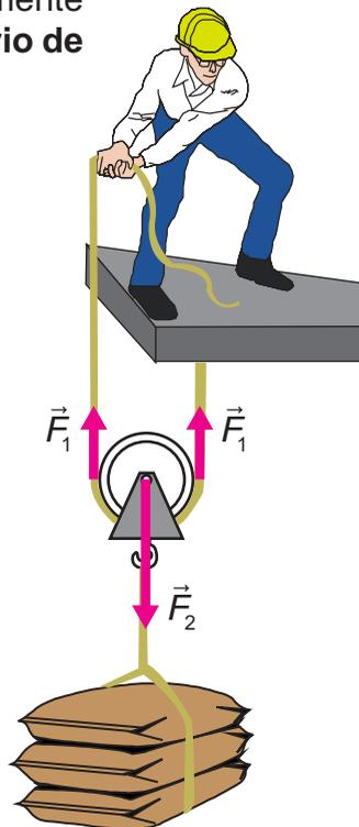
**Fig. 3.21.** En la polea móvil cada lado de la cuerda soporta la mitad del peso de la carga, por lo que la ganancia de fuerza es 2.
