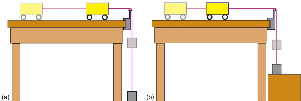
**Fig. 1.13.** Sobre el carrito actúa la tensión del hilo, que desaparece cuando la carga que cuelga llega al suelo (a), o topa con un bloque (b). En (a) la energía cinética que adquiere el carrito es mayor que en (b), lo cual indica que el trabajo realizado por la tensión del hilo fue mayor.
