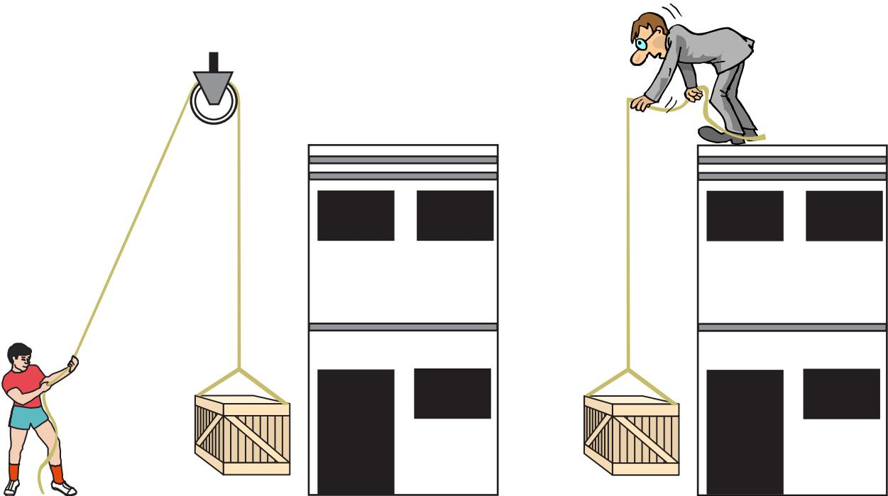
Fig. 3.19. Resulta más cómodo, y menos peligroso, elevar una carga utilizando una polea fija.
