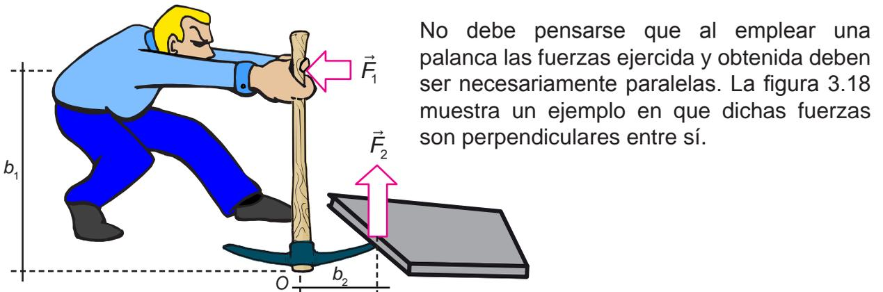
**Fig. 3.18.** En una palanca las fuerzas ejercida y obtenida no necesariamente son paralelas entre sí.
