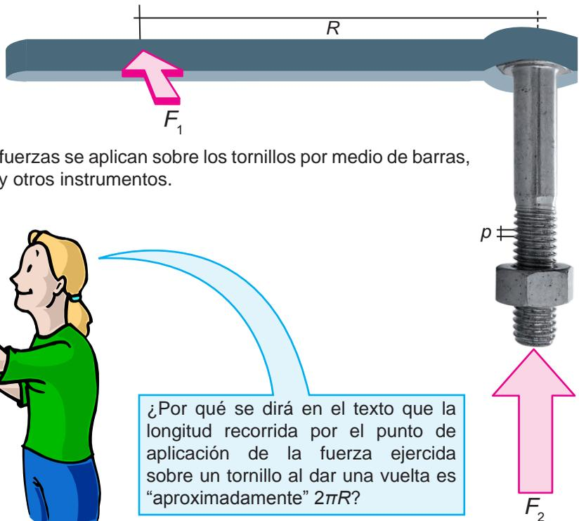
**Fig. 3.33.** Las fuerzas se aplican sobre los tornillos por medio de barras, atornilladores y otros instrumentos.
