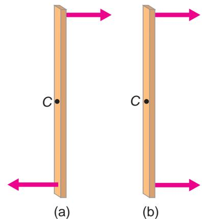
**Fig.14.** Las condiciones de equilibrio de traslación y rotación son independientes una de otra. En (a) la regla está en equilibrio de traslación pero no de rotación y en (b) está en equilibrio de rotación pero no de traslación.
