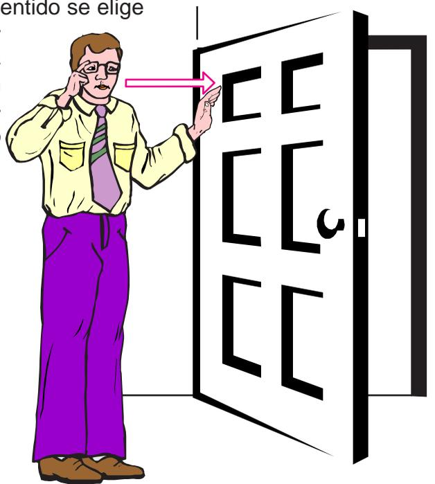
**Fig. 3.9.** Con una fuerza pequeña y un brazo grande es posible obtener el mismo efecto en la rotación de un cuerpo que mediante una fuerza grande y un brazo pequeño.
