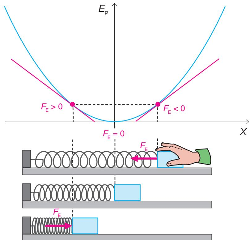
**Fig. 1.27.** La tangente a la curva de  $E_p(x)$  para el sistema cuerpo-resorte, proporciona información acerca de la fuerza ejercida sobre el cuerpo.
