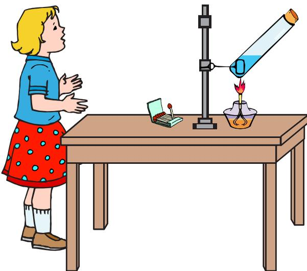
**Fig. 1.34.** El mechero comunica energía térmica al agua contenida en el tubo de ensayo y llega un momento en que parte de esa energía se transforma en energía mecánica del tapón.
