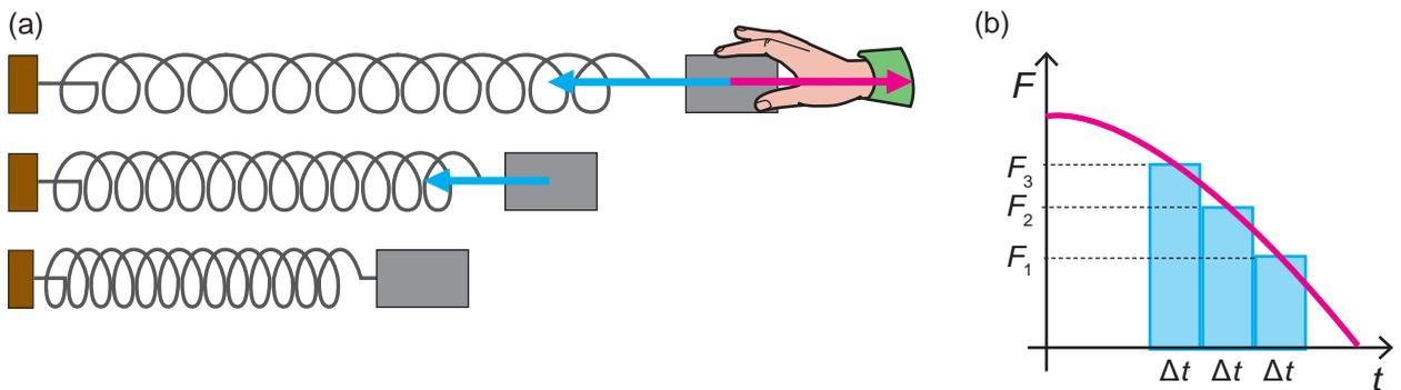
**Fig. 2.2.** Cálculo del impulso de una fuerza cuando su módulo no es constante: a) se divide el intervalo de tiempo considerado en subintervalos muy pequeños y se halla la suma de los impulsos de la fuerza en cada uno de ellos; b) el impulso de la fuerza está dado por el área entre el gráfico  $F(t)$  y el eje de  $t$ .
