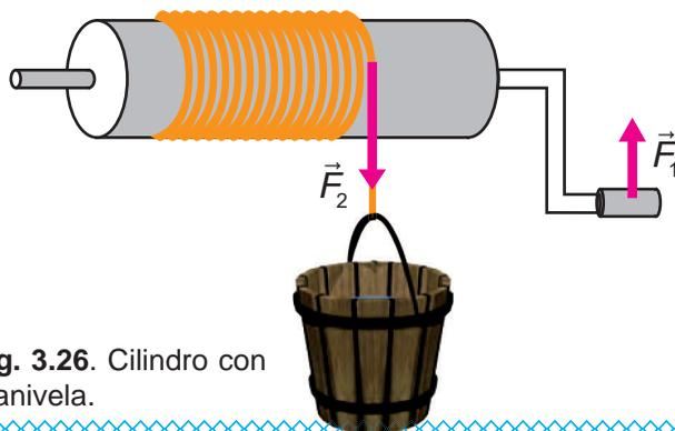
Fig. 3.26. Cilindro con manivela.
