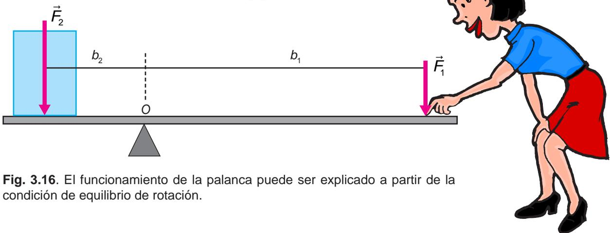
**Fig. 3.16.** El funcionamiento de la palanca puede ser explicado a partir de la condición de equilibrio de rotación.
