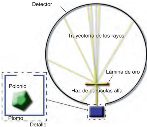
**Fig. 2.6.** Esquema del experimento de Rutherford y sus colaboradores. Al bombardear una fina lámina de oro con partículas alfa, éstas son desviadas. Solo una ínfima cantidad rebota directamente hacia atrás, lo que sugirió que prácticamente toda la masa de los átomos se concentra en una pequeñísima región con carga eléctrica positiva.
