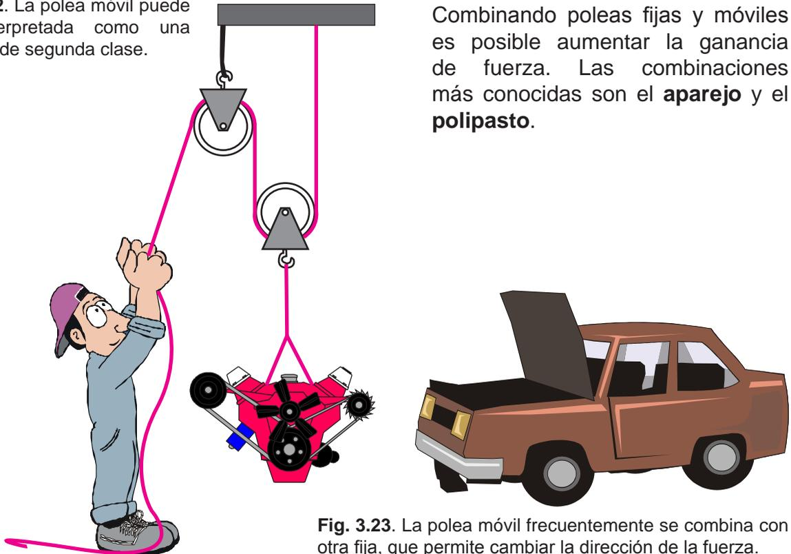
**Fig. 3.23.** La polea móvil frecuentemente se combina con otra fija, que permite cambiar la dirección de la fuerza.
