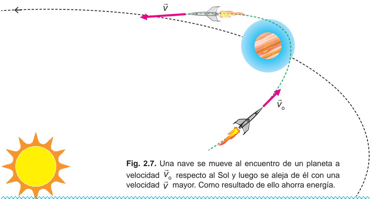
**Fig. 2.7.** Una nave se mueve al encuentro de un planeta a velocidad  $\vec{v}_0$  respecto al Sol y luego se aleja de él con una velocidad  $\vec{v}$  mayor. Como resultado de ello ahorra energía.
