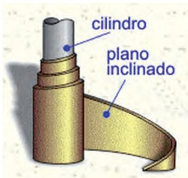
**Fig. 3.30.** Modelo de plano inclinado helicoidal.
