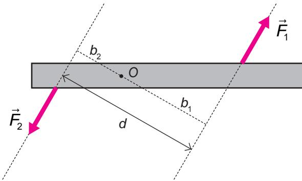
**Fig. 3.11.** Las fuerzas  $\vec{F}_1$  y  $\vec{F}_2$  aplicadas sobre la regla forman un par de fuerzas. La magnitud del momento del par es  $dF$ , donde  $F$  es la magnitud de las fuerzas y  $d$  la distancia entre sus líneas de acción. Por consiguiente, no depende del lugar del cuerpo donde actúan las fuerzas, ni de la dirección de éstas.
