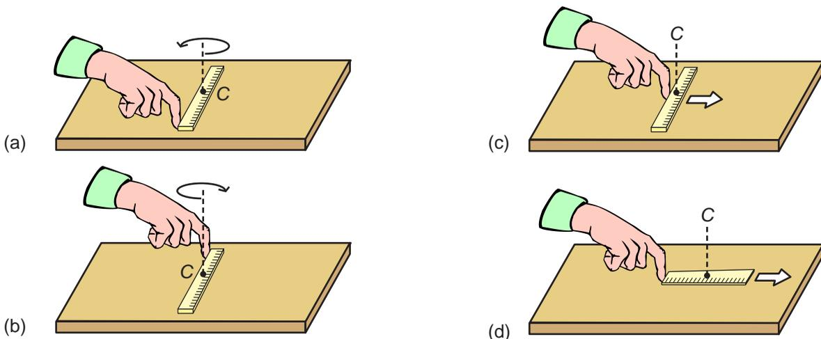
**Fig. 3.5.** El efecto de la fuerza aplicada sobre una regla depende del punto donde está aplicada, así como de su dirección y sentido.
