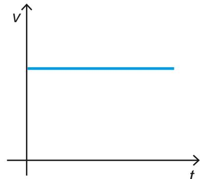
**Fig. 3.8.** Gráfico velocidad-tiempo para un movimiento rectilíneo uniforme.
