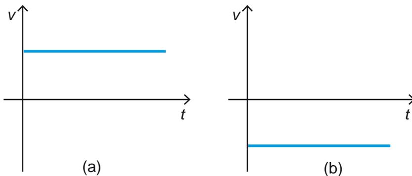
**Fig. 3.10.** Gráficos velocidad-tiempo para el movimiento rectilíneo uniforme: a) el movimiento se realiza en el sentido elegido como positivo, b) el movimiento se realiza en sentido contrario.
