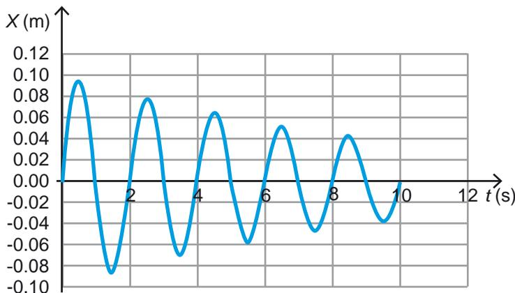
**Fig. 3.36.** Gráfico de las oscilaciones de un péndulo con resistencia al movimiento.
