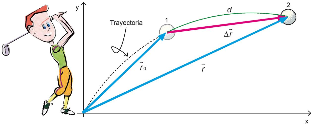
**Fig. 2.7.** Desplazamiento y distancia. El desplazamiento  $\vec{\Delta r}$  une determinada posición con otra posterior y es una cantidad vectorial. La distancia  $d$  es el camino recorrido medido sobre la trayectoria y es una cantidad escalar.
