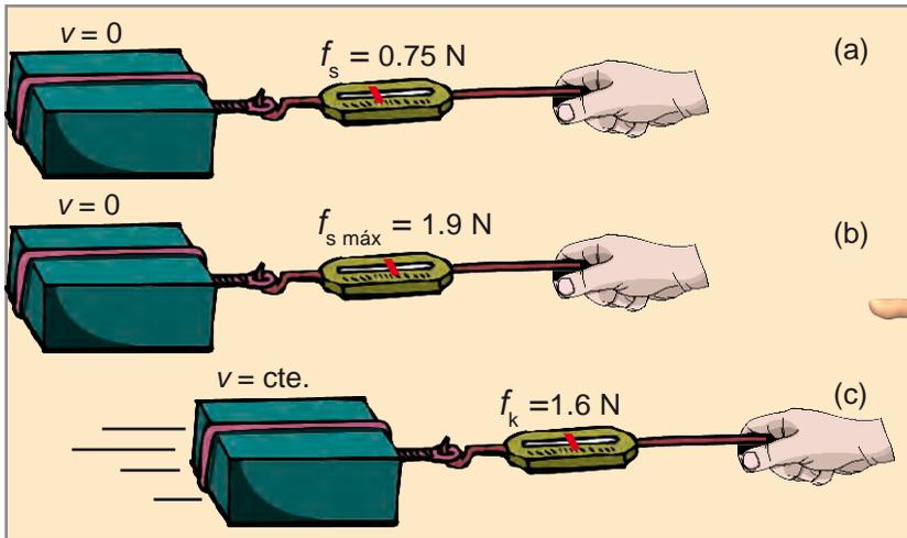
**Fig. 2.34.** En cada caso sobre el bloque actúan en la dirección horizontal dos fuerzas, la del dinamómetro y la de rozamiento. En (a) la fuerza del dinamómetro es mucho menor que la de rozamiento estático máxima y en (b) se aproxima a ella. En (c), la fuerza del dinamómetro es de igual valor que la de rozamiento, que en este caso es cinético.
