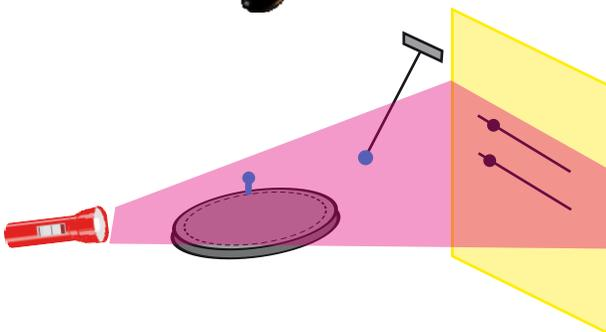
**Fig. 3.30.** Si la velocidad angular del disco y la longitud del péndulo se escogen adecuadamente, las sombras de las esferitas realizan igual movimiento.
