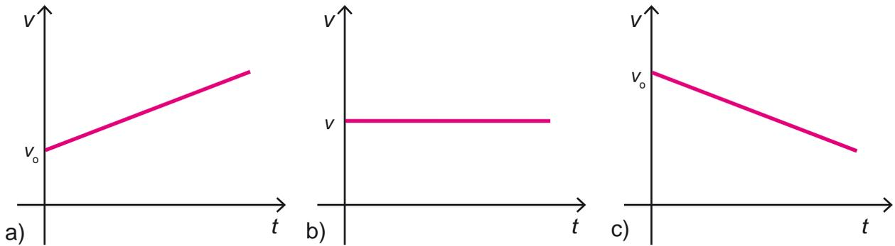
**Fig. 3.11.** Gráficos de velocidad en función del tiempo para el movimiento uniformemente acelerado: a) aceleración positiva, b) aceleración cero y c) aceleración negativa
