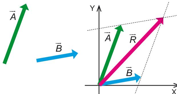
**Fig. 1.25.** Trazado del vector resultante mediante el método del paralelogramo.
