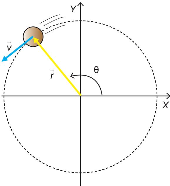
**Fig. 3.22.** Velocidad angular es la rapidez con que varía la posición angular, la cual es constante en el movimiento circular uniforme.
