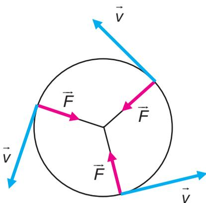
**Fig. 3.20.** En un movimiento circular uniforme hay una fuerza perpendicular a la velocidad de valor constante. Por otra parte, no hay fuerza en la dirección de la velocidad, por lo que su valor permanece siempre el mismo.
