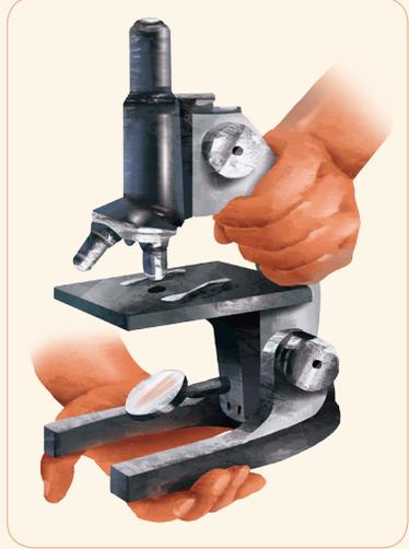
Modo correcto de cargar y transportar un microscopio.
