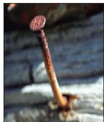
Fig. 1.39 Corrosión del hierro.
