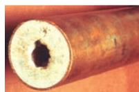
**Fig. 2.42** Tubería obstruida por sarro.
